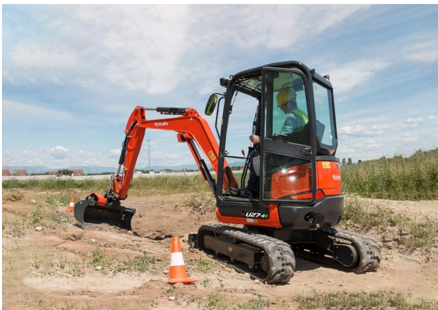
Photo : Mini-pelle KUBOTA U27-4e (retrofit électrique)
