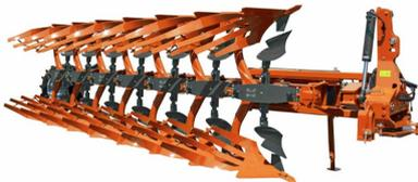
Diese robusten Grindeln sind so vorgeformt, dass Schweißnähte und damit Schwachstellen vermieden werden. Die Grindeln sind hohl, um das Pfluggewicht, den Hubkraftbedarf und die Zugkräfte zu optimieren und damit den Kraftstoffverbrauch zu minimieren.
