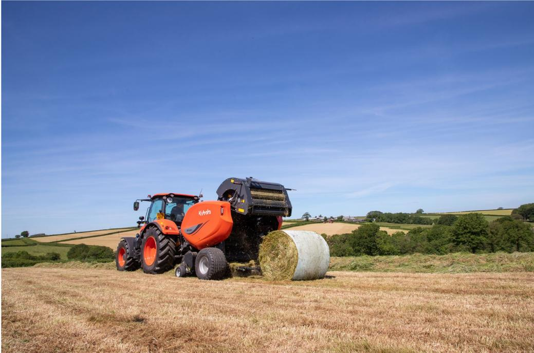
Image : Kubota BF3500 produisant des balles à haute densité
