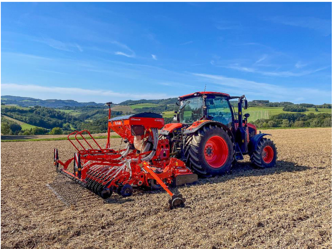
Obraz 1: Kubota SD1301M, szerokość robocza 3,00 m, nabudowana na bronie wirnikowej Kubota PH1001
