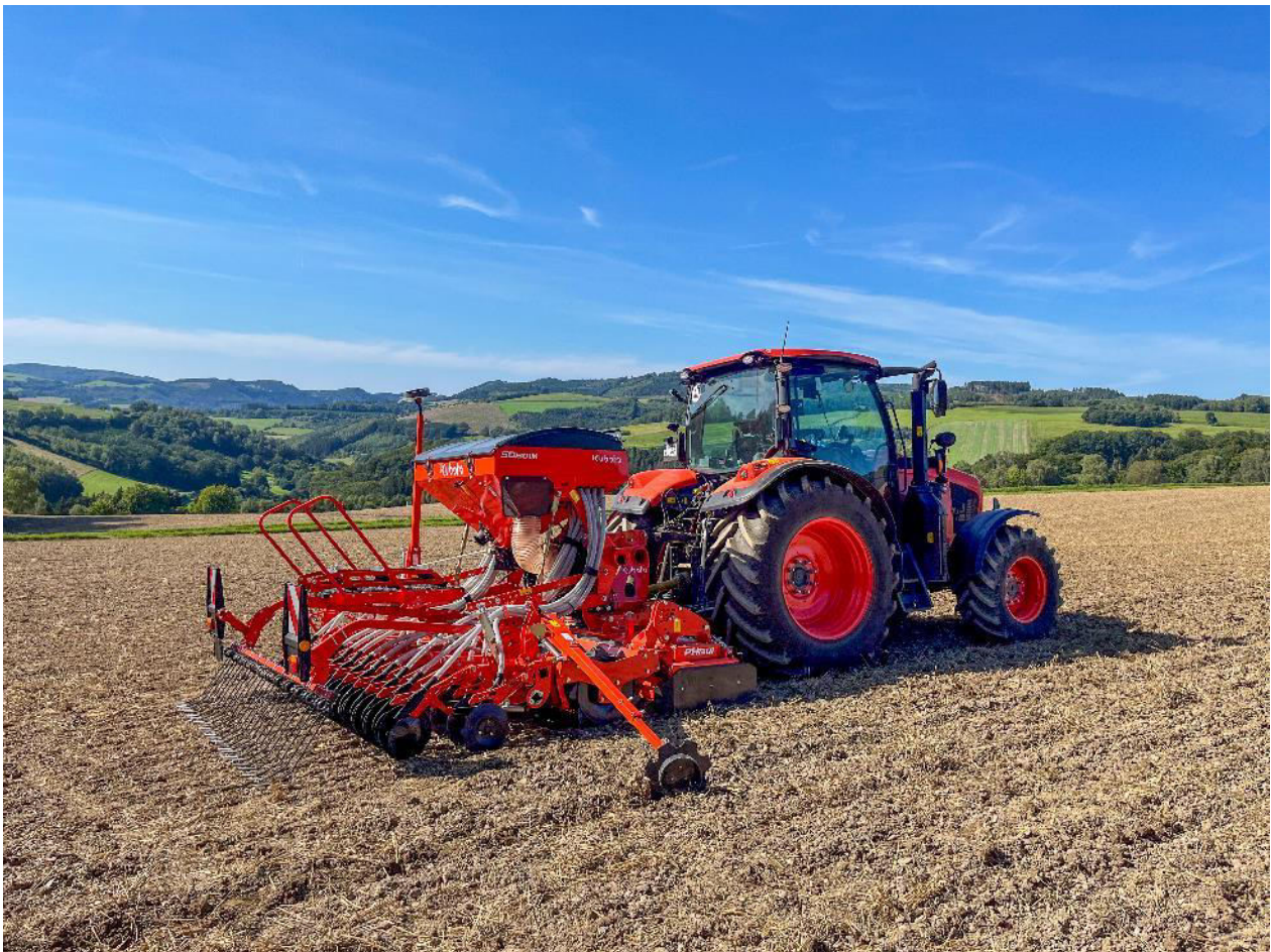
Kubota SD1301M, 3.00m de largeur de travail, monté sur une herse rotative Kubota PH1001
