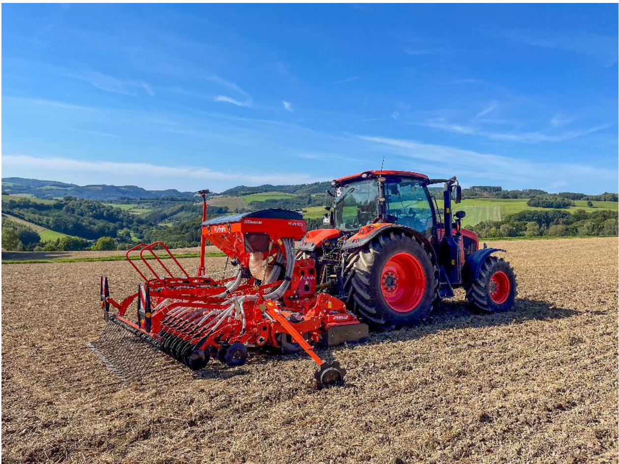
<Kubota SD1301M, 3,00 m de ancho de trabajo, montada sobre grada rotativa Kubota PH1001
