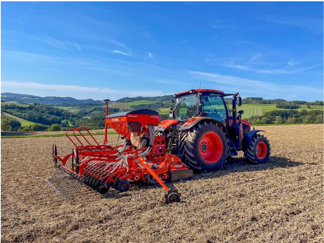
<Kubota SD1301M, 3,00 m Arbeitsbreite, montiert auf der Kreiselegge Kubota PH1001
