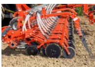
Obraz 4: Redlica Kubota Clamped CX-II z kołem dociskowym
