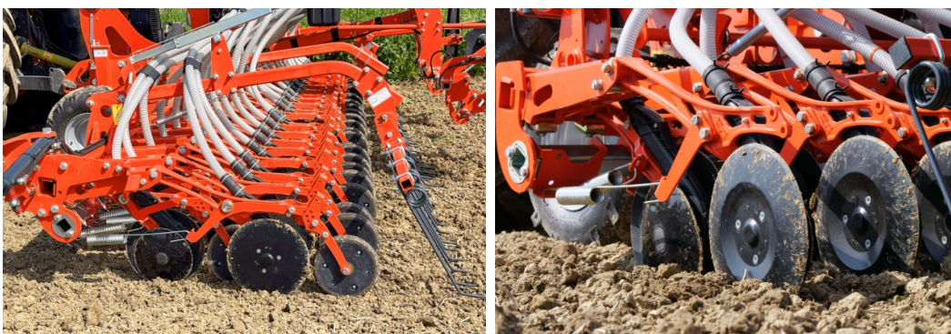
Obraz 4/5: Redlica Kubota CX-II zaciskana z/bez koła dociskowego
