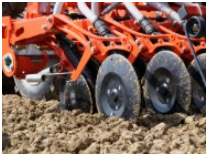
Immagine 5: Coltro Kubota Clamped CX-II senza ruota di pressione
