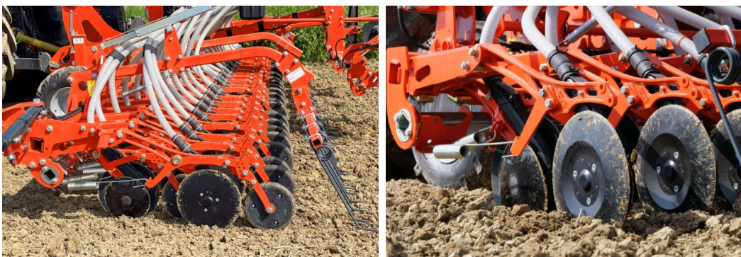
Immagine 4/5: Coltro Kubota clamped CX-II con/senza ruota di pressione
