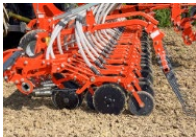
Image 4 : Soc Kubota CX-II à serrage avec roue de presse
