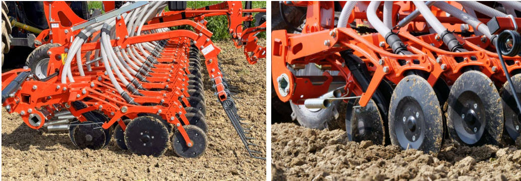
Elément semeur CX-II bridé Kubota avec/sans roue plombeuse
