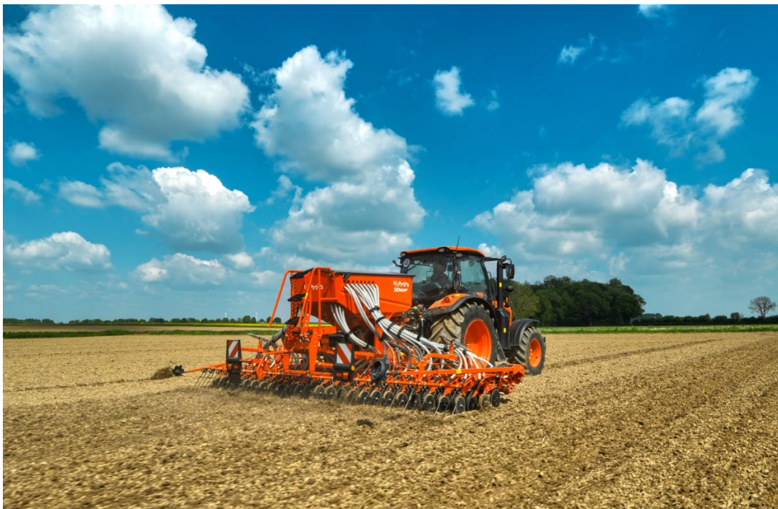
Kubota SD1601F, largeur de travail de 6,00 m, modèle e-com, entièrement compatible ISOBUS
