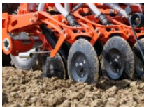
Image 5 : Kubota Soc CX-II serré sans roue de presse
