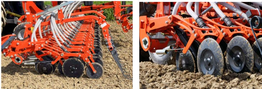
Bild 4/5: Kubota geklammertes CX-II Schar mit/ohne Andruckrolle
