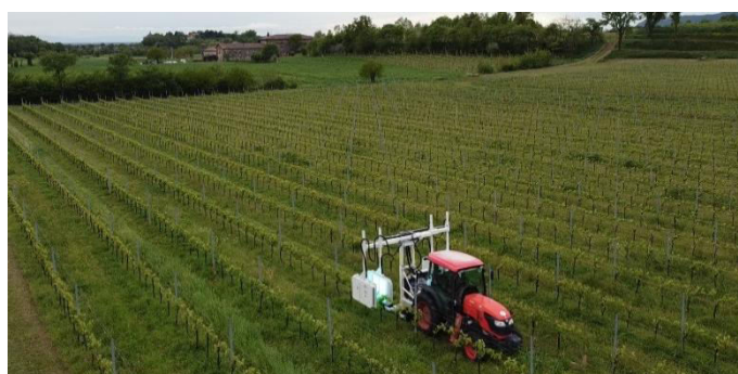
Picture 1/2 : UV Boosting : stimulation des défenses naturelles des plantes par des "flashes" d'UV-C
