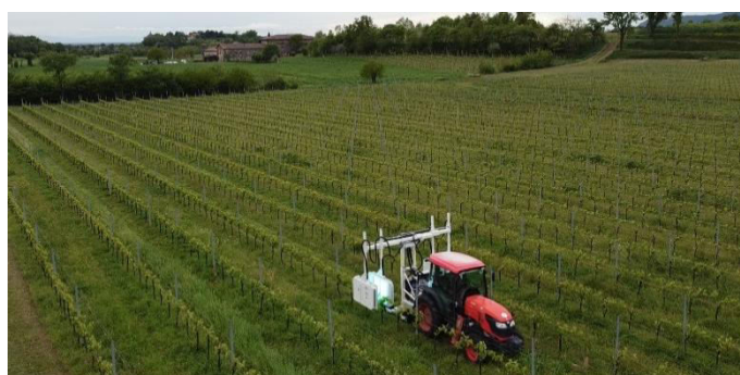
Picture 1/2 : UV Boosting estimula las defensas naturales de las plantas mediante los llamados "flashes" UV-C
