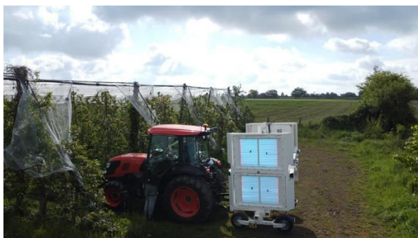
Picture 1/2 : UV Boosting estimula las defensas naturales de las plantas mediante los llamados "flashes" UV-C
