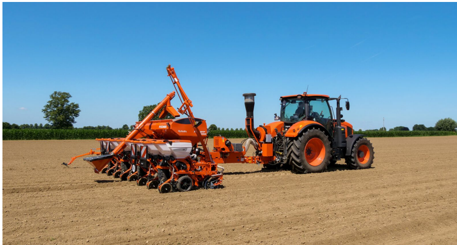
PP1601TF con fila di semina SX ad alta velocità e sistema PUDAMA
