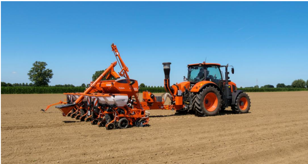
Image: Le semoir de précision PP1601TF équipé d'éléments semeurs haute vitesse SX et du système PUDAMA
