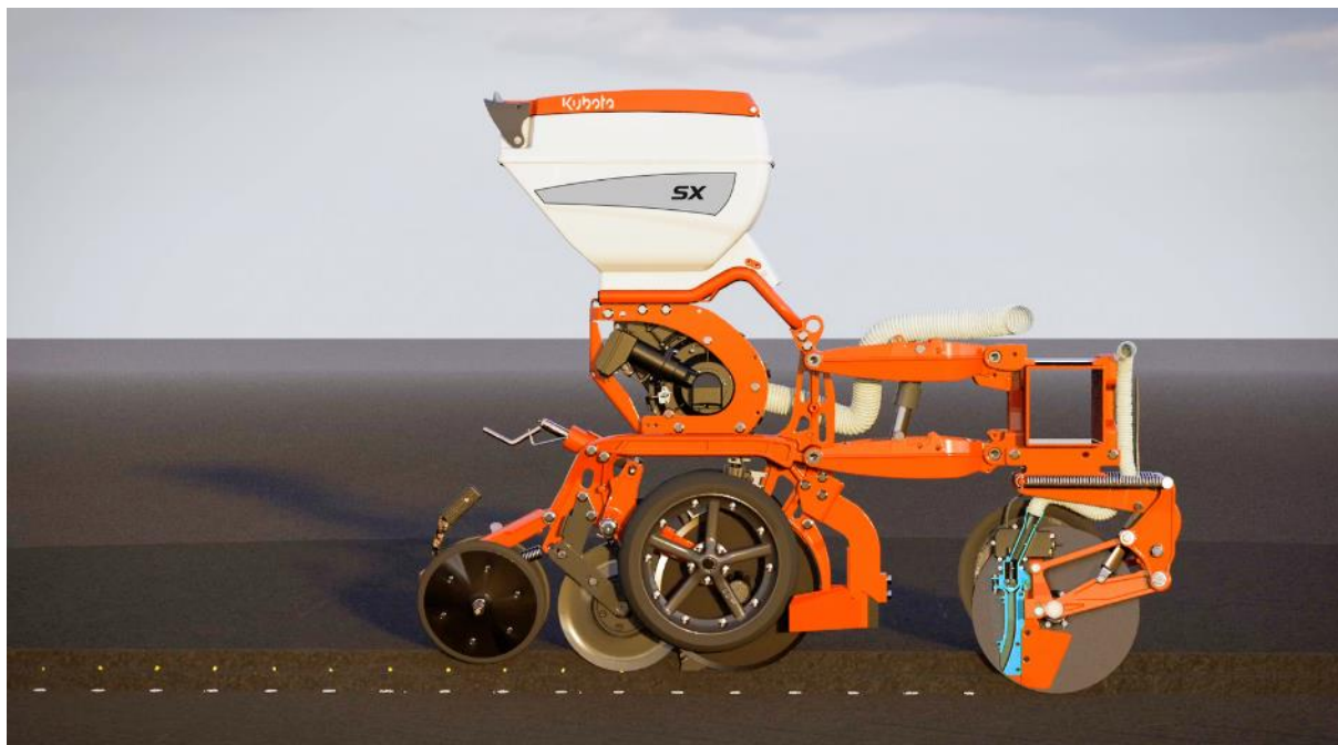
Image : Avec le système PUDAMA, l'engrais starter est placé par paquet en-dessous de chaque graine.
