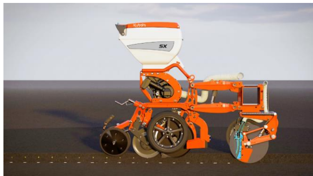
Bild: Kubota PP1601TF SX PUDAMA legt ein Düngerdepot unter jedes Saatgut.
