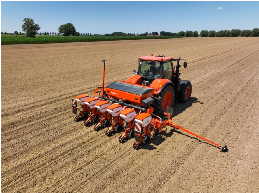
Kompaktowy siewnik punktowy Kubota PP1451V z ramą o zmiennej szerokości roboczej
