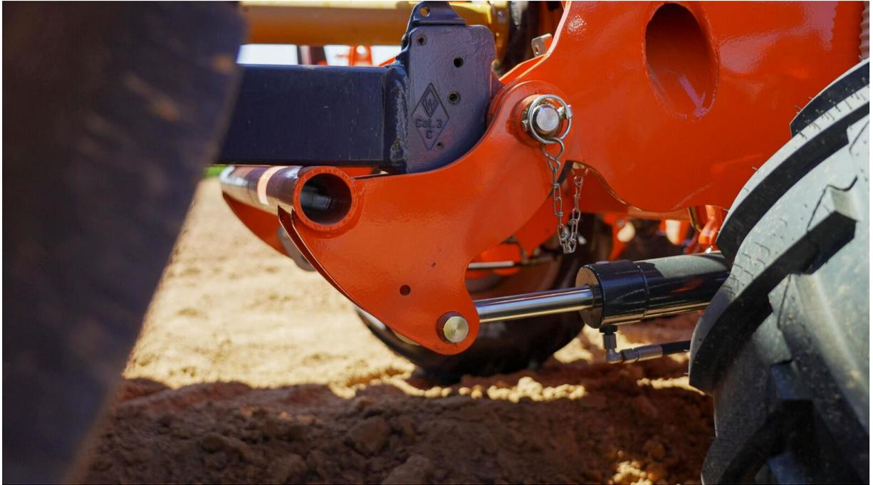
*Image : Le semoir PP1451V est équipé d'un kit de lestage hydraulique du châssis amélioré.*
