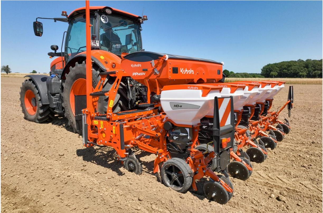
*Image : Kubota PP1451V équipé des éléments semeurs HD-II et de la nouvelle trémie 60l*
