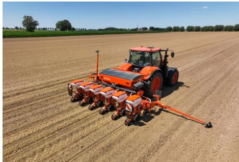
Bild: Kubota PP1451V kompakte Einzelkornsämaschine mit variabler Reihenweite
